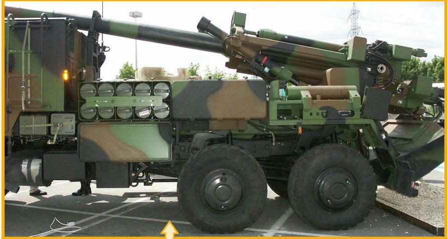
Vue détaillée du flanc gauche du châssis du Caesar avec l'emplacement pour les obus. Detailed view of the left side of the Caesar chassis with the space for the munitions.
