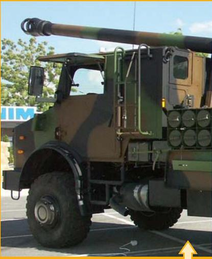
Une cabine entièrement blindée est montée à l'avant du véhicule. A fully enclosed cab has been mounted at the front of the vehicle.
