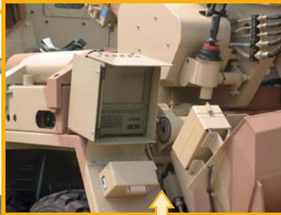
A l'arrière gauche du châssis se trouve l'écran de contrôle de tir, lorsque le véhicule est en position de tir. At the rear on the left is the gun display unit for the crew when the system is deployed in the firing position.
